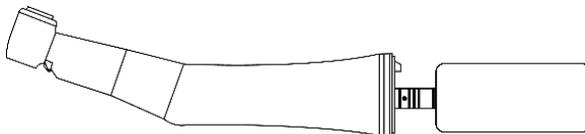
Ölen Sie die O-Ringe am Motor leicht mit MK-dent Premium Service Öl LU1011.
