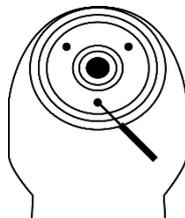
Entfernen Sie Blockaden in den Spraykanälen vorsichtig mit der beiliegenden Düsennadel.
